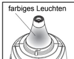
Wird bei dem NUK Baby Thermometer 2 in 1 eine Körpertemperatur gemessen, die gleich  $37,5^{\circ}\text{C}$  ( $99,5^{\circ}\text{F}$ ) ist oder diese übersteigt, leuchtet im Sondenkopf ein rotes Licht, um den Benutzer vor möglichem Fieber zu warnen. Liegt die Temperatur unter  $37,5^{\circ}\text{C}$  ( $99,5^{\circ}\text{F}$ ), leuchtet ein grünes Licht.
