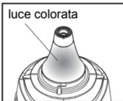
Quando il termometro per bambino 2 in 1 NUK rileva una temperatura corporea superiore o uguale a 37,5°C (99,5°F), nella testina della sonda si accende una luce rossa per avvisare l'utente della possibile presenza di febbre.
