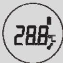
Nach dem Umschalten wird die Raumtemperatur auf dem LCD-Display angezeigt. Das Temperatursymbol wird dargestellt.
