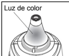
Si la temperatura que mide el termómetro para bebé 2 en 1 es igual o superior a los 37,5 °C (99,5 °F), se enciende una luz roja en el cabezal de sonda para alertar de la posibilidad de fiebre. Si la temperatura es inferior a 37,5 °C (99,5 °F), se enciende una luz verde.
